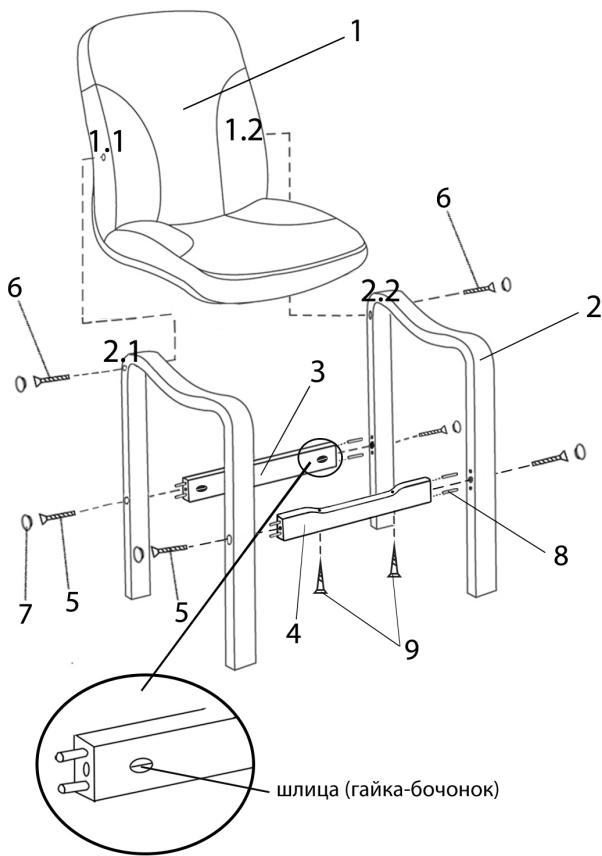
**Внимание!** Проверьте внутреннюю сторону царги (3,4). Шлица на гайке должна быть строго параллельна оси царги. При необходимости выровняйте шлицу отверткой (вставьте отвертку в шлицу и поверните влево/вправо). Отвертка в комплект фурнитуры не входит.
